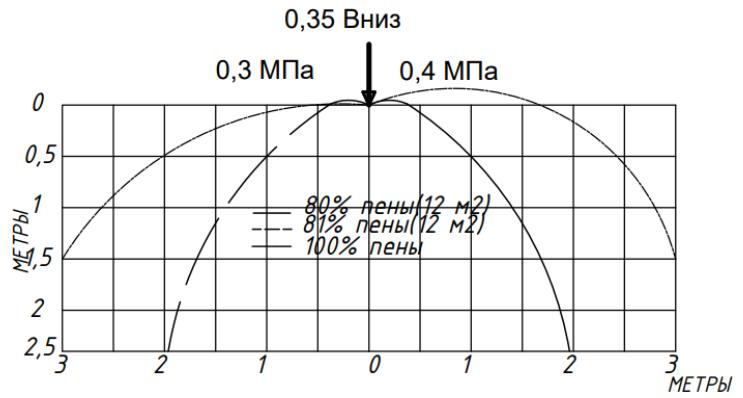
**Графики зависимости интенсивности орошения от давления для оросителей водяных и пенных при высоте установки 2,5 м и площаи 12 м<sup>2</sup>**
